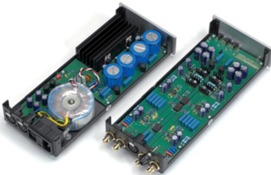
Professionelle Fertigung, hochwertige Bauteile, viel Aufwand in der Stromversorgung, bequeme Kapazitäts- und Impedanzanpassung via „Mäuseklavier“
